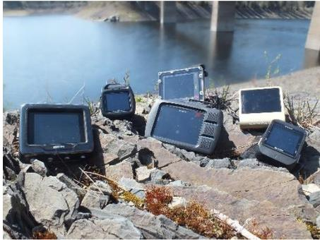
technischen Wunderwerken übernommen (*Foto 2: Die von Tauchern der TGN getesteten Tauchcomputer an der Okertalsperre*). Sie messen und überwachen kontinuierlich die Tauchzeit, die Tauchtiefe und berechnen dabei das Profil des Tauchgangs und die daraus resultierenden Dekompressions- bzw. Sicherheitsstopps. Die modernen Geräte der neusten Generation bieten darüber hinaus noch viele zusätzliche Features, wie z.B. farbig einstellbare
